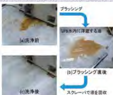
図2 UFB混入水のみでブラッシングした工作機械下の固着作動油汚れの床洗浄
