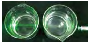
図1 ビーカー右側からレーザー光照射した様子(左はUFB混入水道水、右は水道水のみ)
