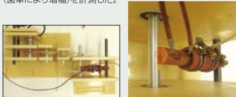
動力生成装置の試作機
