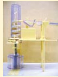
水流エネルギー回収・保存システム
