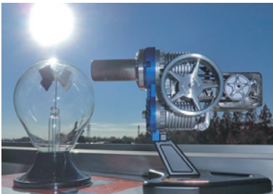
熱を動力に変えるクリーンなエネルギー変換装置
