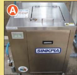
生ごみを、運ばず・燃やさず・その場で処理しています。(水とCO<sub>2</sub>にバイオ処理)ダイニングホール: 能力100kg/日×1台
