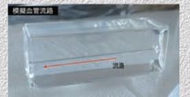
▲図1.模擬血管流路
