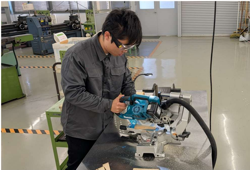
建築用の 2×4材、 1×6材を切り出し、 丸鋸を使って必要サイズに加工
