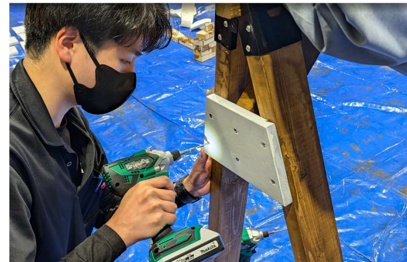
部品の下穴開け・ネジ止めなどの前加工 ⇒ 組み立てテスト
