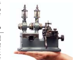
●手の平に乗せた時計用小型工作機械
