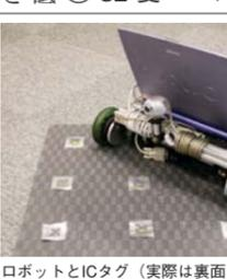
ロボットとICタグ(実際は裏面に設置)
