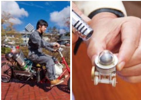
左：人間乗車クラス 右：マイクロスターリングエンジン搭載車両
