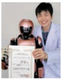
気モーターが油圧シリンダに限られているため、より人間的な動作をさせるためには、従来にはない小型化、軽量化が必要になる。SMAは小型軽量ながら大出力が発生でき、最適な駆動源の一つとして期待されている。本研究では、本学所有のヒューマンノイドロボット「ニコット」にSMAを用いた駆動装置を搭載し、身振りや手ぶりなどの非言語コミュニケーションを行わせた。これは世界初の試みと抱負を述べている。
