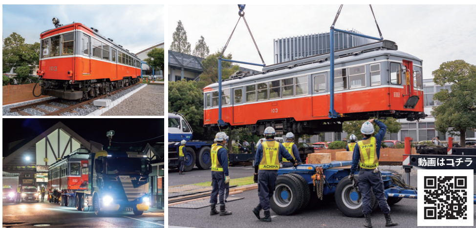
左上：展示スペースに設置された車両 左下：強羅駅を出発するトレーラー 右：クレーンによる設置作業
